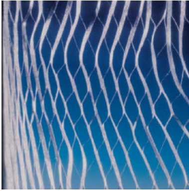
フィブリレーションはフラットフィルムを立体的な構造に（糸など）
