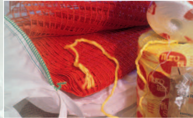
Nähgarn für Big Bags sowie Schnüre werden typischerweise aus fibrillierten Bändchen gemacht
