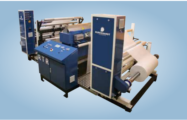
Unsere eigene Perforierlinie steht für alle Arten von Versuchen und industrielle Lohnperforation zur Verfügung
