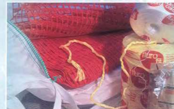
典型裂膜成型的FIBC缝纫线及绳
