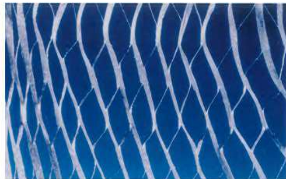
平膜裂膜成形（如丝线构造）
