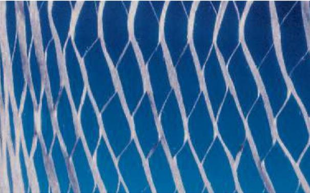
*Fibrillation kann flache Folien zu einer 3-dimensionalen Struktur umwandeln (z.B. Garne)*
