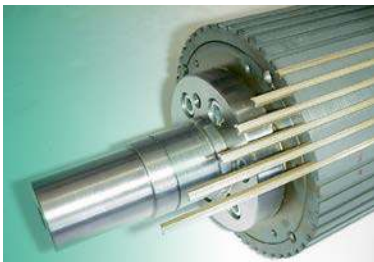
ローラーの着脱なしでパールの取替可能
