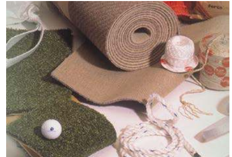
人工芝、カーペットの裏地 ロープの材料はフィブリレイションした フィルムやテープ
